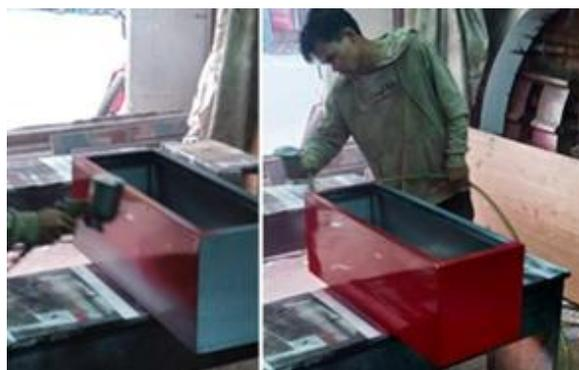
Gambar 9. Pengecatan Totem Sign
