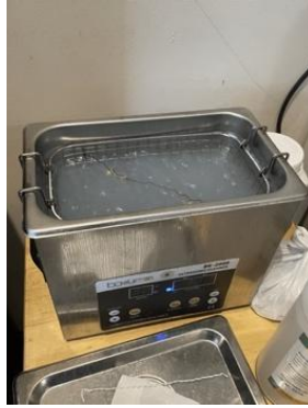
Gambar 13.4. Pembersihan sisa pemolesan dengan alat ultrasonic cleaner (sumber: pribadi).
