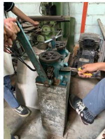
Gambar 4. Penggilingan dengan alat Press Rolling Mill (sumber: pribadi).
