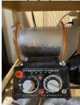
Gambar 13.2. Finishing dengan alat mini tumbler (sumber: pribadi).
