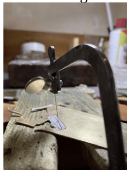
Gambar 9. Pemotongan manual dengan gergaji emas (sumber: pribadi).
