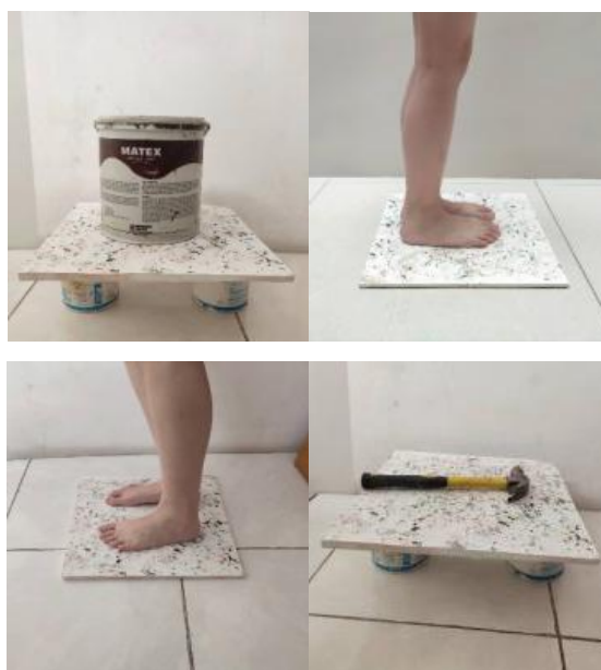
Gambar 2. Uji kekerasan dengan beban benda berat dan diinjak
