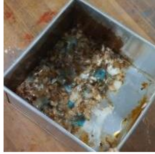
Gambar 5. Temperatur oven terlalu panas sehingga plastik gosong pada Eksperimen 3
