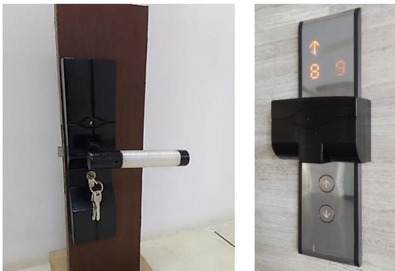
**Gambar 3.** (a) Hasil purwarupa alat UV untuk *handle* pintu, (b) Purwarupa alat untuk tombol panel lift
