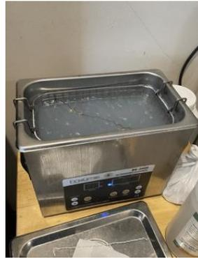
**Gambar 13.4.** Pembersihan sisa pemolesan dengan alat *ultrasonic cleaner* (sumber: pribadi).
