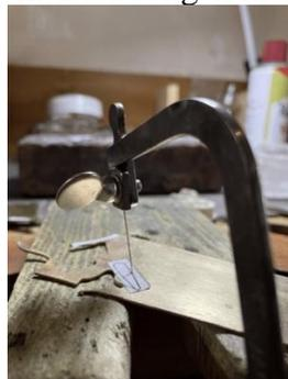
**Gambar 9.** Pemotongan manual dengan gergaji emas (sumber: pribadi).
