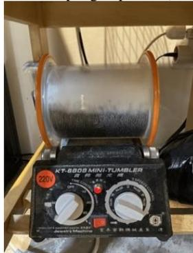
**Gambar 13.2.** *Finishing* dengan alat *mini tumbler* (sumber: pribadi).
